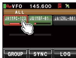
3 Коснитесь на экране выделенной радиостанции. Позывной выбранной радиостанции будет мигать.
